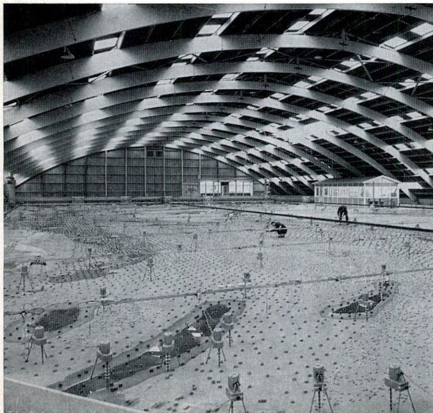
In het model, dat op deze foto niet in bedrijf is, zijn de bodemfiguratie en de coriolis-tollen duidelijk zichtbaar.
